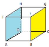
■ Par contre les fuyantes, feront avec les lignes du plan frontal un angle différent de l'angle réel afin de traduire l'effet de perspective. (Dans la réalité, BF et BC sont perpendiculaires alors que ce n'est pas le cas sur le dessin). Les angles que font les fuyantes avec les verticales du plan frontal permettent de simuler une vue de la gauche ou de la droite, une vue en plongée (depuis le haut) ou en contreplongée (depuis le bas).
