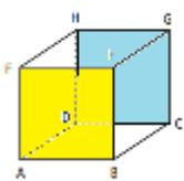
■ Le plan frontal (AEFB) de l'objet dessiné ainsi que les plans parallèles au plan frontal (DHCG) quelle que soit leur forme géométrique) et les objets (points, droites, figures) contenus dans ces plans, ne seront pas déformés sur le dessin. Ils apparaîtront tels qu'ils sont sur le modèle.
